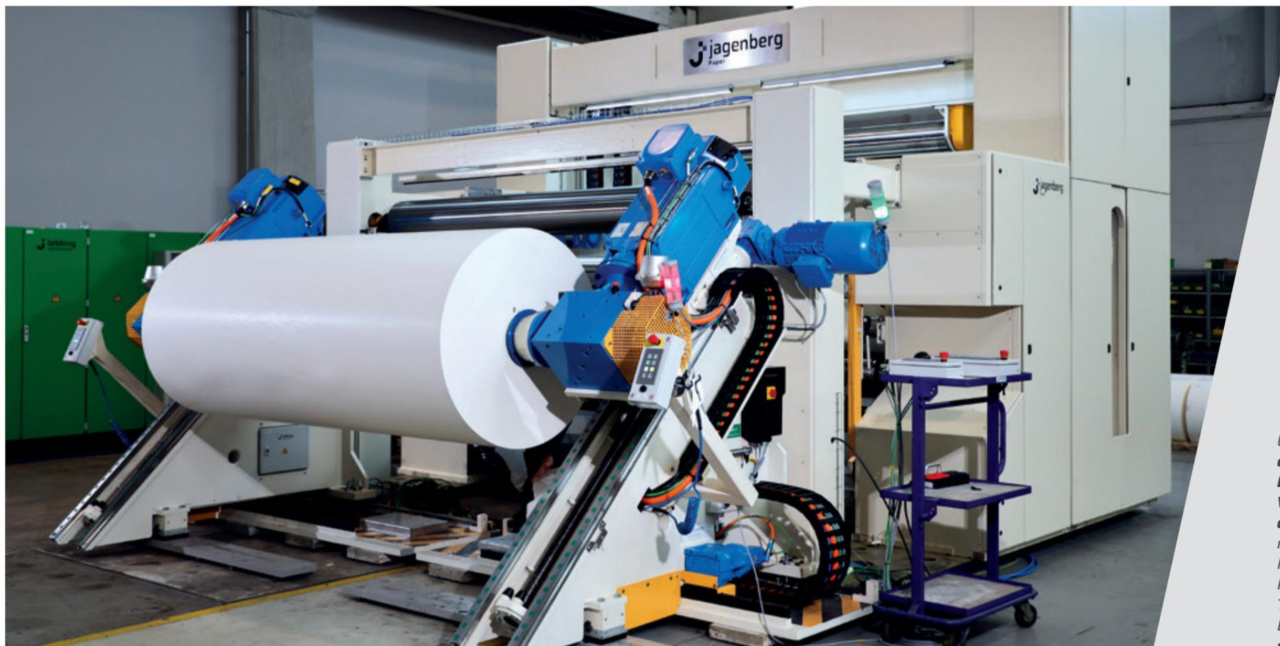
Unter anderem sorgen **Energieeffizienz, Ressourcenschonung, Energierückgewinnung, Verringerung von Ausschuss und digitales Monitoring** für einen nachhaltigen Betrieb unserer Maschinen und Anlagen. Hier im Bild links: Moderne Technik mit Rekuperation zur Energierückführung – der **Rollen-schneider von der Jagenberg Paper GmbH**.
